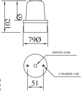
Baliza LED multifunción Giratoria/Intermitente/Fija con 8 modos de funcionamiento. Consta de una base sólida ABS blanca (standard) o negra (opcional) y una lente de policarbonato.
