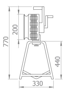
Indicador acústico de aluminio fundido, diseñado como alarma de respaldo cuando se produce un corte de energía o para aplicaciones en las que no se dispone de electricidad.
