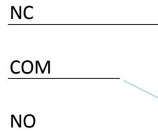
Relé de alarma durante el arranque, alarma activa y/o durante la pérdida de potencia
